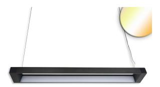
Rendu des couleurs 80 CRI Fréquence 50 Hz Durée de vie 54.000 Heures Sources lumineuses ampoule LED Ampoules incluses? 3000 K, 5700 K Couleur de la lumière Intensité lumineuse 3600 lm Indice de protection IP42 240 V Volt Watt 40 W Certificat Certificat CE Largeur 11,5 cm Largeur réglable non Poids 1,86 kg Hauteur 5,9 cm Réglable en hauteur non Longueur 122,2 cm
